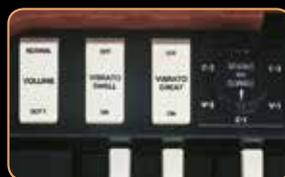
besitzt sechs mögliche Positionen, entsprechend drei Vibrato- und drei Chorus Stufen. Über diesen Schalter werden die Vibrato oder Vibrato-Chorus Einstellungen vorgewählt, die mit den Vibrato Schaltern des jeweiligen Manuals zu- oder weggeschaltet werden.
